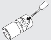
**4** Tournez la borne de l'enceinte dans le sens des aiguilles d'une montre pour la resserrer.
