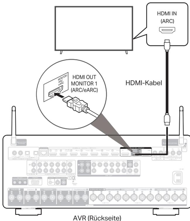
Verwenden Sie ein hochwertiges HDMI-Kabel\* und schließen Sie ein Ende an den mit "eARC" oder "ARC" gekennzeichneten HDMI-Anschluss an Ihrem Fernseher an. Schließen Sie das andere Ende an den HDMI OUT MONITOR 1-Anschluss an Ihrem AVR an.
