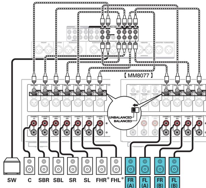
\* Los altavoces de altura, altavoces de techo y altavoces Dolby Atmos Enabled se pueden conectar a los terminales del altavoz HEIGHT1. Establezca el altavoz que se vaya a conectar mediante la opción "Altura" - "Distribución" del menú. (☞ p. 220)
