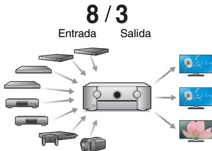
Para la conexión a una amplia gama de fuentes digitales, esta unidad incorpora 8 entradas HDMI, incluyendo 1 en el panel frontal que le permite conectarse de una manera cómoda y rápida a una videocámara, consola de videojuegos u otros dispositivos equipados con HDMI. Dispone de salidas HDMI duales para la sala principal y una tercera salida HDMI para la otra habitación.
