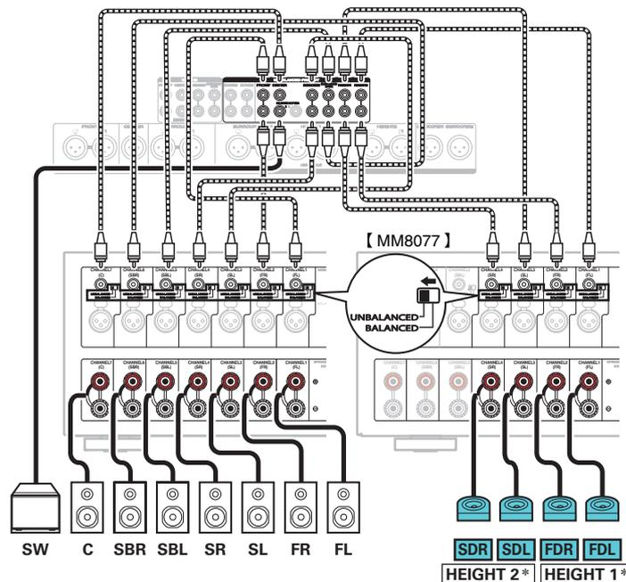
\* Puede cambiar la combinación de los canales HEIGHT1 y HEIGHT2 en la configuración. (☞ p. 66)
